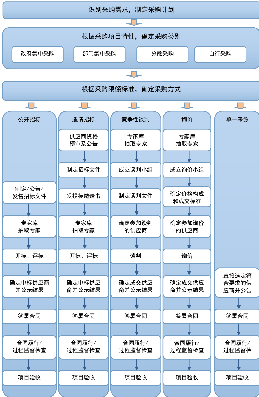
图 5-4 生态环境部（国家核安全局）重大设备和服务的采购控制流程示意图
